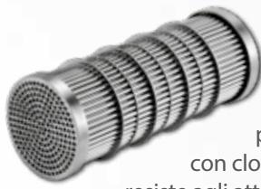
Il titanio è il materiale perfetto per gli scambiatori di calore per piscine. Può essere usato con ogni tipo di acqua per piscina – inclusa acqua salata o con cloratore per acqua salata – poiché resiste agli attacchi degli agenti chimici aggressivi indefinitamente.
