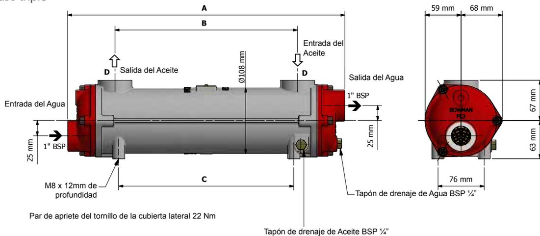
Par de apriete del tornillo de la cubierta lateral 22 Nm
