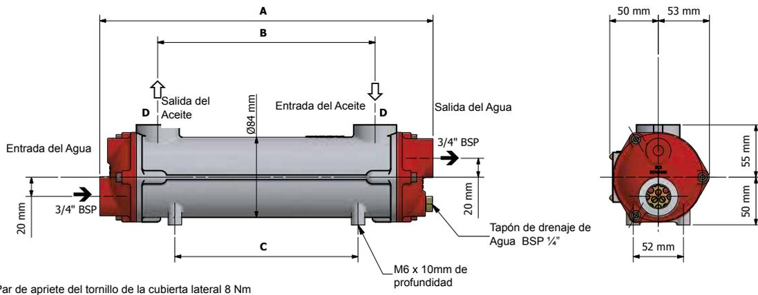
Par de apriete del tornillo de la cubierta lateral 8 Nm
