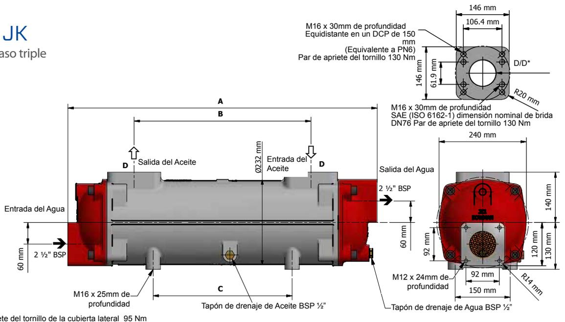
Par de apriete del tornillo de la cubierta lateral 95 Nm
