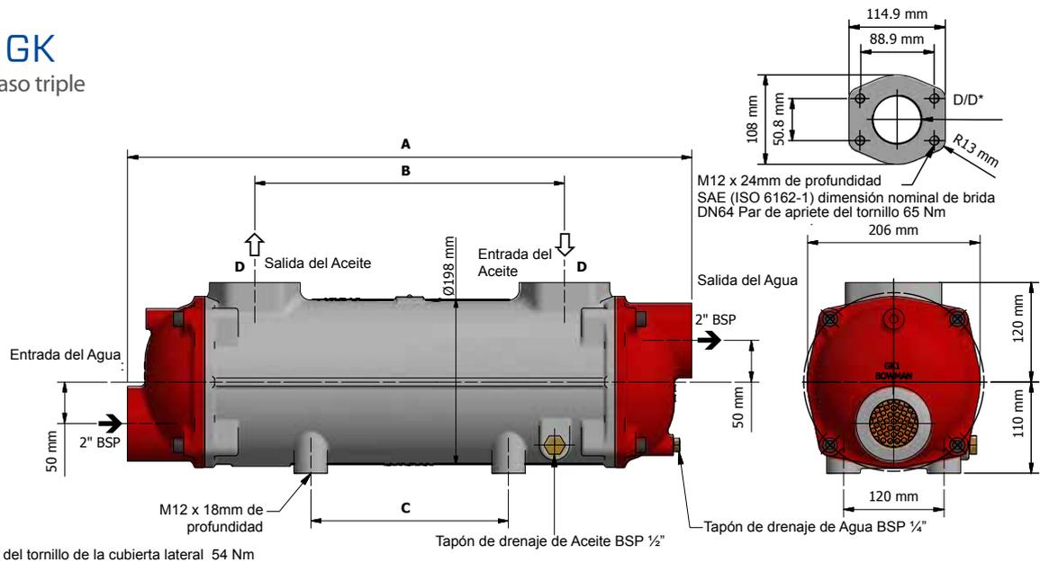
Par de apriete del tornillo de la cubierta lateral 54 Nm
