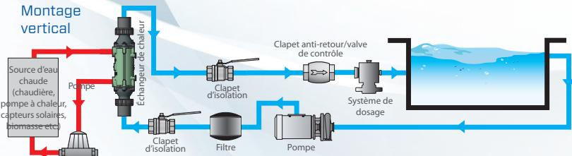
L'échangeur de chaleur peut être endommagé par des produits chimiques. Des systèmes de dosage doivent être installés en aval de l'échangeur de chaleur intégrant un clapet anti-retour / une valve de contrôle. Si des produits chimiques sont utilisés, les gaz doivent être empêchés de pénétrer dans l'échangeur de chaleur lorsque le système de filtration n'est pas utilisé.
