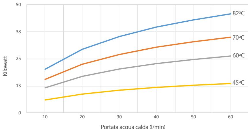
kW di trasferimento di calore - EC100-5113-2
