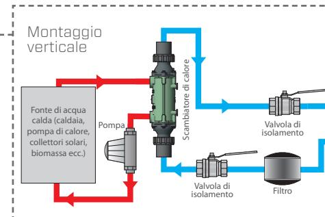
Se viene aggiunto un sistema di dosaggio automatico, deve essere installato dopo lo scambiatore di calore sul ritorno in piscina.
