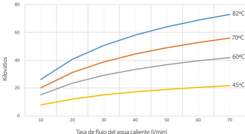
Transferencia de calor en kW - EC120-5113-3
