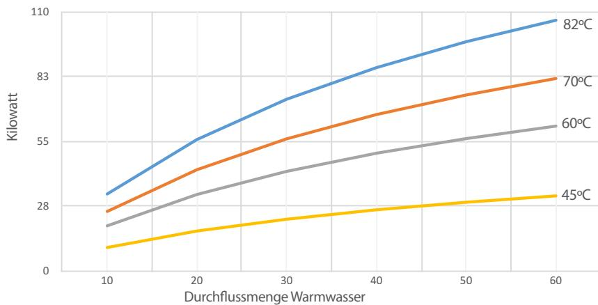
Wärmeübertragung kW – EC160-5113-5
