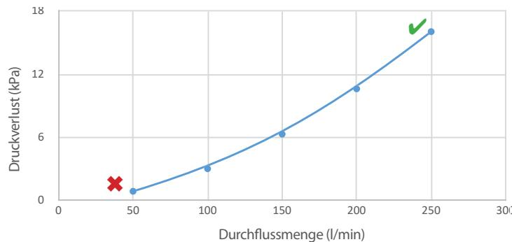
✓ Optimale Wärmeübertragungsleistung   ✗ Reduzierte Wärmeübertragungsleistung
