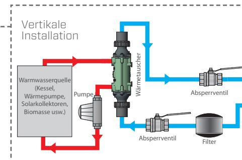
Falls ein automatisches Dosiersystem eingebaut wird, muß es nach dem Wärmetauscher im Rücklauf zum Schwimmbad angebracht werden.
