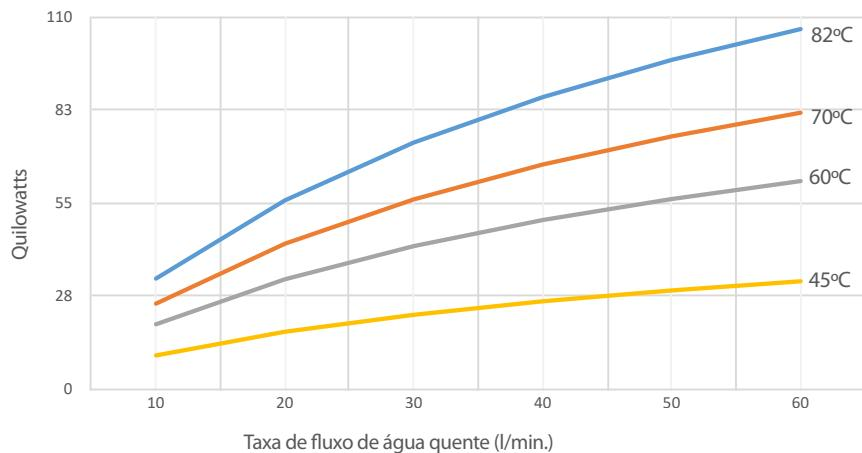
Transferência de calor kW - EC160-5113-5
