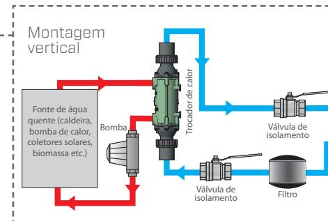
Se for adicionado um sistema de dosagem automática, ele deve ser instalado após o trocador de calor no retorno à piscina.
