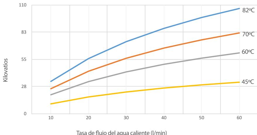
Transferencia de calor en kW - EC160-5113-5
