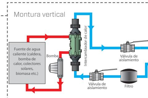
Si se agrega un sistema automático de dosificación, debe instalarse luego del intercambiador de calor en el retorno de la piscina.
